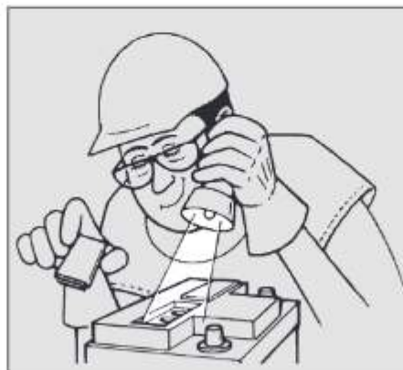
شکل ۶۰: کنترل سطح آب باتری
