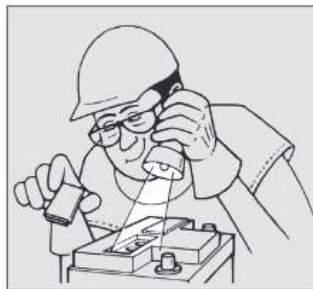
شکل ۱۲: کنترل سطح آب باتری
