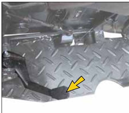
شکل ۷: پدال قفل دیفرانسیل
