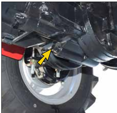
شکل ۳۲: پیچ تخلیه روغن گیربکس جلو
