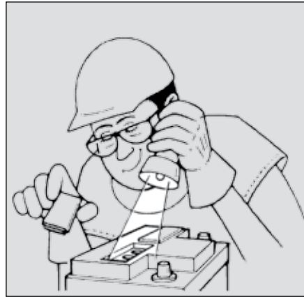
شکل ۱۲: کنترل سطح آب باتری
