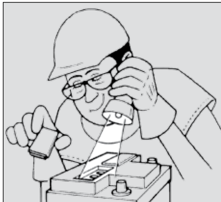
شکل ۴۲: کنترل سطح آب باتری
