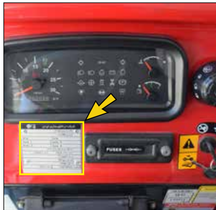
شکل ۱: محل پلاک شماره سریال تراکتور
