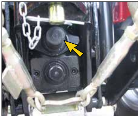
شکل ۱۸: محافظ و درپوش محور انتقال نیرو
