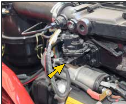
شکل ۱۸: اهرم پمپ دستی
