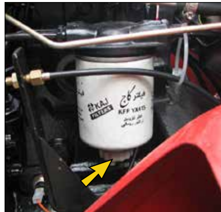
شکل ۱۵: مهره تخلیه فیلتر گازوئیل
