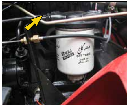
شکل ۱۷: لوله خروج سوخت
