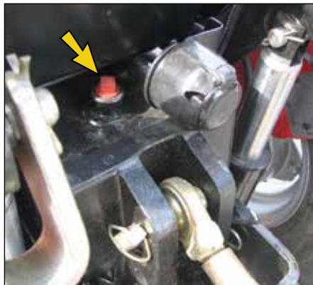
شکل ۳۵: محل ریختن روغن مخزن هیدرولیک
