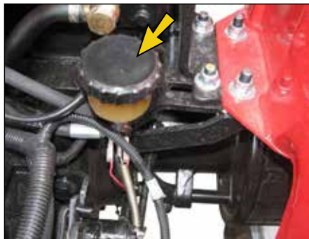
شکل ۳۰: مخزن روغن قفل دیفرانسیل
