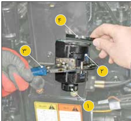
شکل ۱۶: نحوه تعویض فیلتر سوخت
