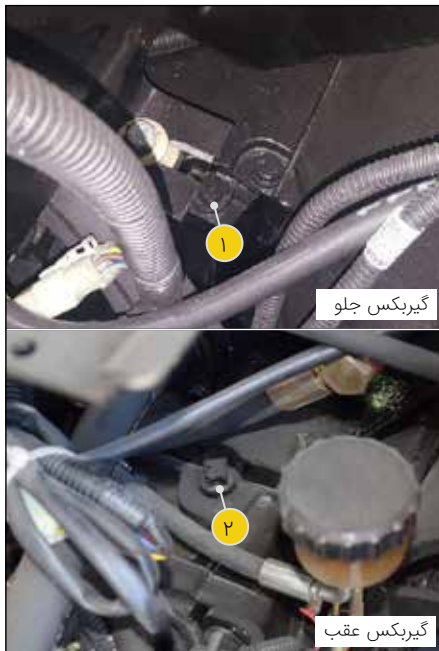
شکل ۳۱: درپوش ریختن روغن گیربکس
