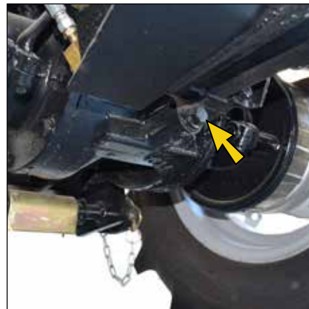
شکل ۳۳: پیچ تخلیه روغن گیربکس عقب
