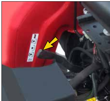
شکل ۹: اهرم مخصوص P.T.O
